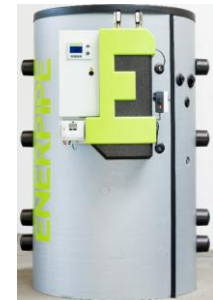
Pufferspeicher „HP1000ZL“ mit innenliegendem Heizwendelwärmetauscher
