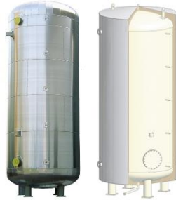
Wärmespeicher 150 m 3 ; Abmessungen: D = 3,5 m; H = 17,1 m
